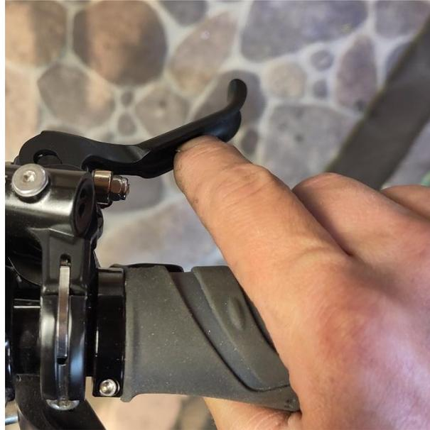
Drücken Sie den rechten Bremsgriff nach vorne, um die Schiebehilfe zu aktivieren. Sie ist ideal um das SpeedPed ohne Kraftaufwand eine Rampe hoch zu schieben. Die Schiebehilfe funktioniert nur mit offener Potistellung.
