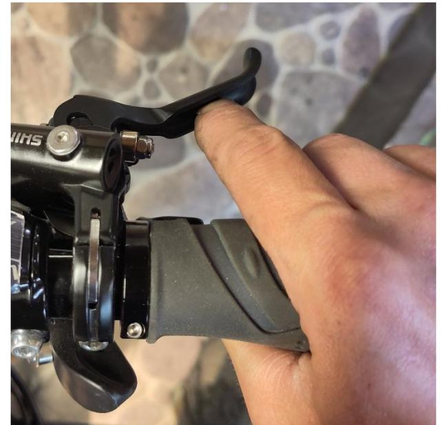
Drücken Sie beide Bremsgriffe nach vorne, um die Anfahrhilfe zu aktivieren. Mit der Potistellung können Sie die Leistung regulieren. Aktiv ist die Anfahrhilfe solange Sie die Bremsgriffe nach vorne drücken. Mit der Anfahrhilfe können Sie die volle Motorenleistung bis 30km/h ohne zu pedalieren. Bitte festhalten!
